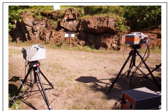
Abb 1. Messaufbau der abbildenden Spektrometer AISA Owl und AISA FENIX zur spektralen Erfassung eines Straßenaufschlusses.
