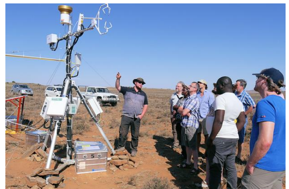
Abb. 1: Aufbau eines Eddy-Kovarianz-Turmes zur Messung von Kohlenstoffdioxid- und Wasserdampfströmen auf Weideland in der Nähe von Middelburg, Eastern Cape, Karoo, Südafrika (© Thünen-Institut/AK)
