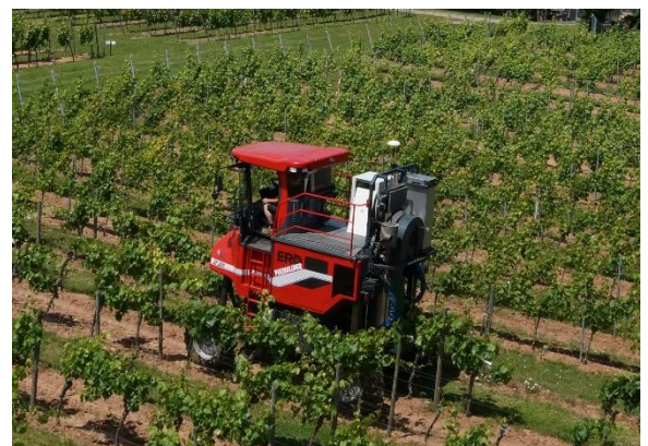
Abb. 1 Phenoliner beim Feldeinsatz. Eine robuste Feld Phänotypisierungsplattform zur automatisierten und schnellen Aufnahme von georeferenzierten Sensordaten.
