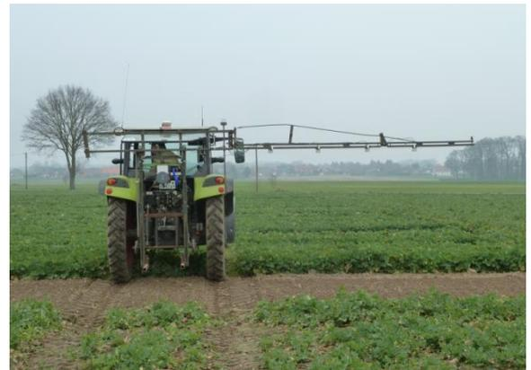
Abb. 2: PentaSpek-System zur mobilen Phänotypisierung von Raps in Zuchtgärten mit RTK-GPS, einem Sensor zur Messung der einfallenden Strahlung und vier Sensoren zur Messung der Reflexion des Rapsbestandes.
