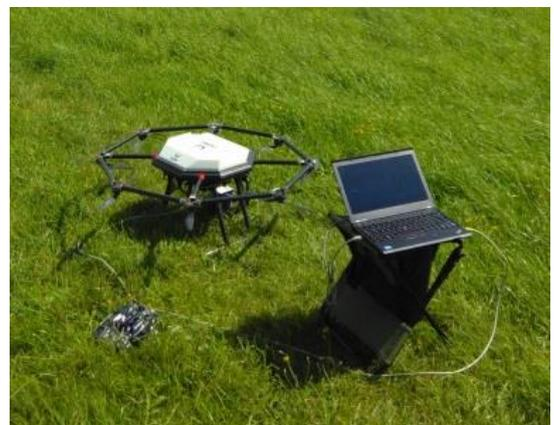
Abb. 1: Der verwendete Multikopter mit der Steuerungseinheit.
